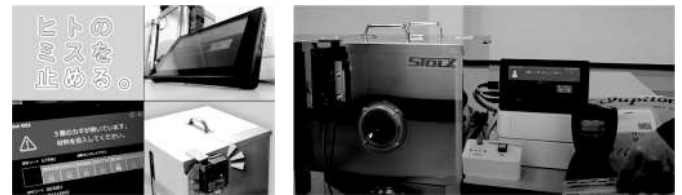
▲材料誤投入防止システム
